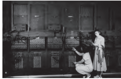
Abb.5: Programmierarbeit am ENIAC (1942-1955) - durch Neverkabelung.
