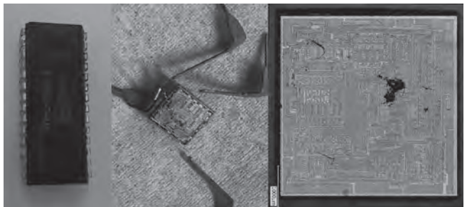
Abb. 8: Fotografie der Oberfläche des AY-3-8500-IC
